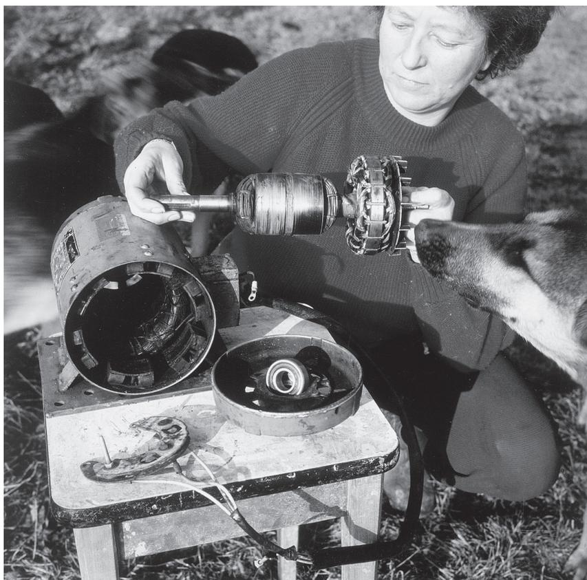
*Obr. 2.4*     *Alternátor Westinghouse, který vyrábí střídavý (třífázový) proud. Vlniti kotvy je buzeno proudem vyráběným pomocným generátorem buzeným permanentním magnetem vpravo na hřídeli.*
