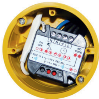
Obr. 7-9 Umístění vestavného přijímače RX11 v elektroinstalační krabici
