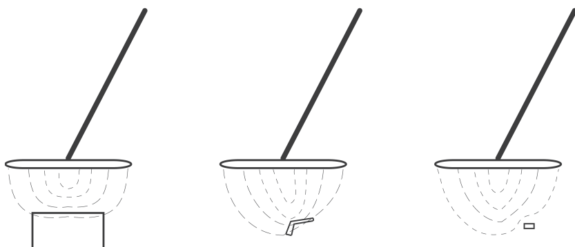
Obr. 2.11 Citlivost hledací sondy na bednu plnou mincí, na pistoli a nemagnetickou minci
