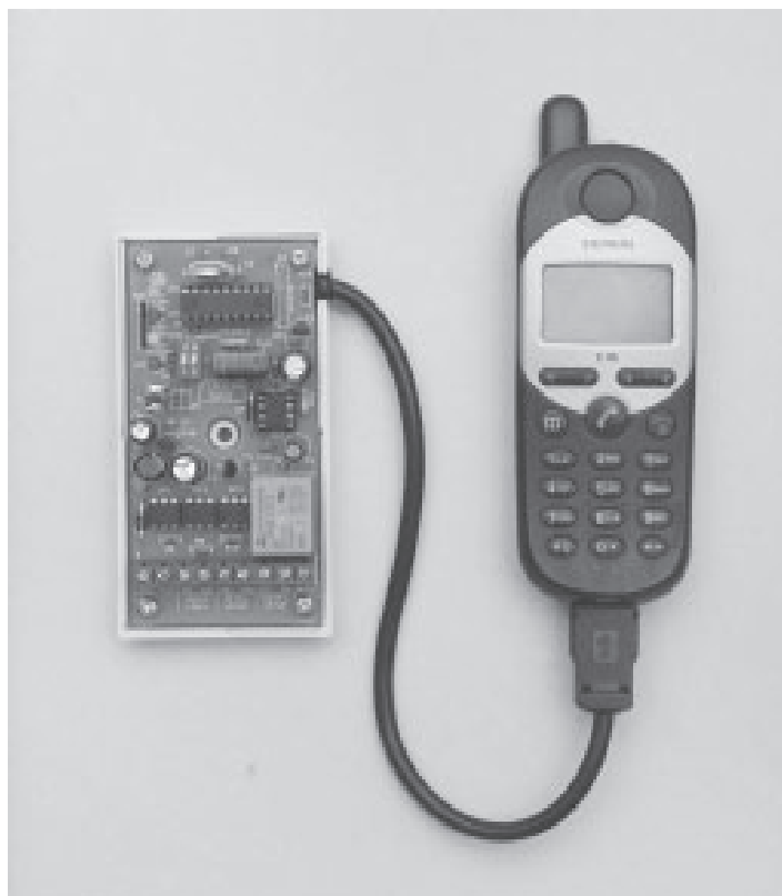
Obr. 11 Fotografie GPA1 s připojeným mobilním telefonem Siemens M55.
