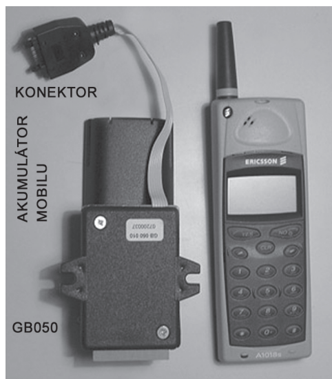
Obr. 3.1 Komunikační procesor GB050 (vlevo připevněný k akumulátoru a s propojovacím kabelem) a s mobil Ericsson A1018A (vpravo)
