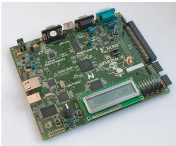
Obr. 44 *Spartan3S500E Starter Kit*
