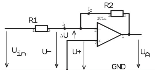
Obr. 12.3    Invertující zapojení OZ
