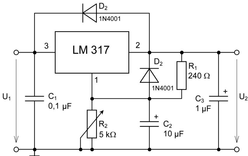
Obr. 6.24 Základní zapojení stabilizátoru LM317
