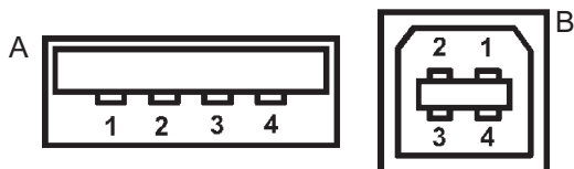
Obr. 2.1 Číslování vývodů na konektorech
